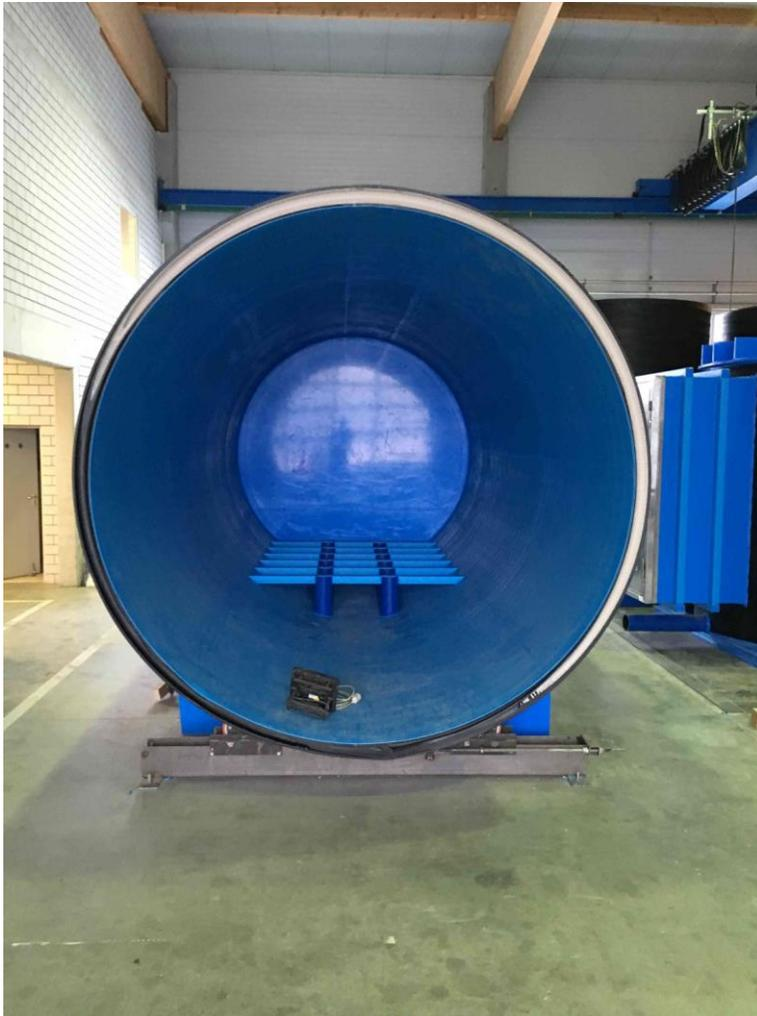
PE Wickelrohr und Bodenträger des Quellsammelschachtes
